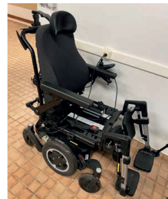
Figure 3 : fauteuil roulant électrique avec assise inclinable, roues motrices au milieu (fauteuil 6 roues), joystick à gauche
