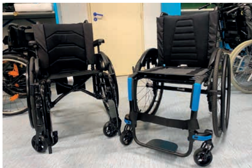
Figure 1 : À gauche : un FRM à châssis pliant avec des accoudoirs et repose-pieds double palette, à droite : un FRM à châssis rigide et plus léger, et repose-pied monobloc
